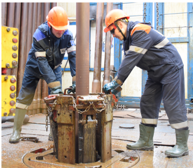
Помощник буровика эксплуатационного и разведочного бурения скважин на нефть и газ 5-го разряда (второй) Ринат Султанбеков и буровик эксплуатационного и разведочного бурения скважин на нефть и газ 6-го разряда Андрей Прудников выполняют работы по снятию клинвев для наращивания буровой колонны
